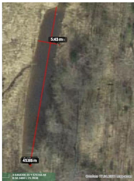
Joonis 2.3. Projekteeritud segmendikujuline settebassein raadiusega 40 m maastikul Kõpu MPÜ tellitud projektis.
